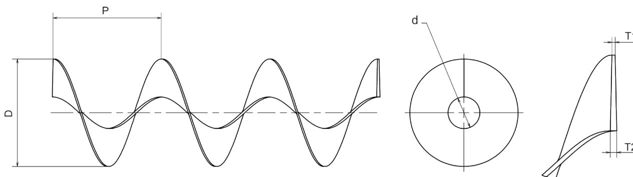
Šnekové spirály jsou vyráběny na základě technických specifikací, dodaných zákazníkem. Je třeba znát přesné údaje - venkovní průměr, stoupání, vnitřní průměr, sílu materiálu a jakost materiálu. Potřebujeme také vědět, zda se jedná o spirálu určenou do bezosého dopravníku, nebo spirálu následně montovanou na hřídel. Tento údaj je důležitý pro určení priority vnitřního, nebo vnějšího průměru.
