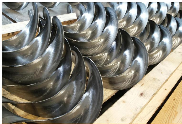
K dostání jsou robustní spirály s konstantní silou materiálu nebo šnekové spirály s rozdílnou silou materiálu na vnitřní a vnější straně spirály. Dále je možné vyrobit spirálu složenou z několika profilů. Šneková spirála může být vyrobena i na přesně požadovanou délku.
